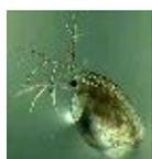
Cet essai permet d'évaluer la toxicité aiguë d'une matrice liquide, et en particulier d'un éluat. Il est effectué selon la norme NF EN ISO 6341, avec des daphnies (crustacés aquatiques) issues de l'élevage du laboratoire et âgées de moins de 24h.
