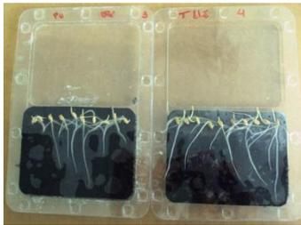
L'essai d'inhibition de la germination et de la croissance des racines de semences végétales en microplaques permet d'évaluer la toxicité aiguë de matériaux vis-à-vis de végétaux terrestres. Cet essai est effectué en microplaques, en suivant le protocole du fabricant. Comme pour les essais en pots ci-dessus, le support de culture témoin est le sol de référence ISO<sup>1</sup>) humidifié avec de l'eau du réseau déchlorée par aération douce.
